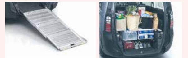
スーパーフレックススロープ 普段はフラットな荷室の床として、引き出せばそのままスロープとして、前に倒せば2段収納が可能なラゲッジスペースに。さまざまなシーンで便利に使える「スーパーフレックススロープ」が、生活に新しい可能性を生み出します。
